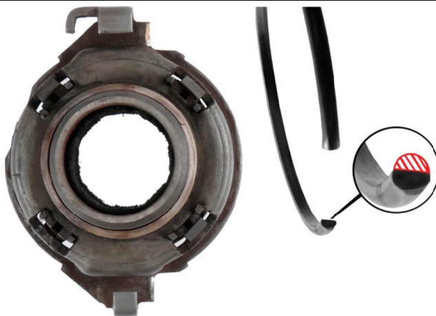
Ilustracja 4: Wyprężnik: mocno spłaszczony pierścień zabezpieczający
