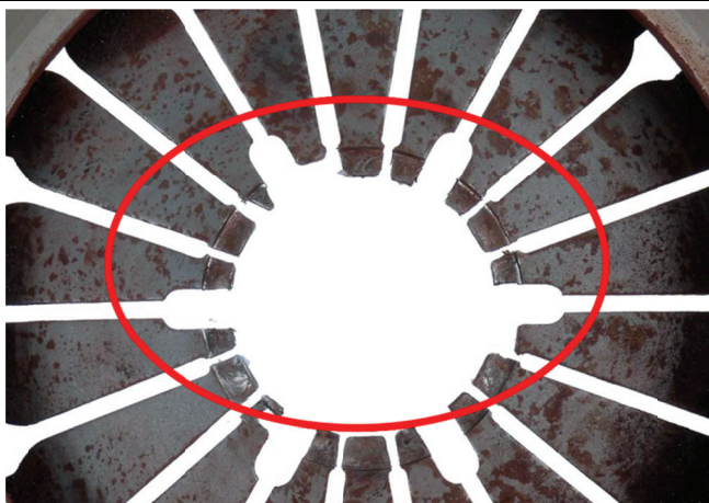
Ilustracja 3: Sprzęgło odciągane: przetarta sprężyna membranowa
