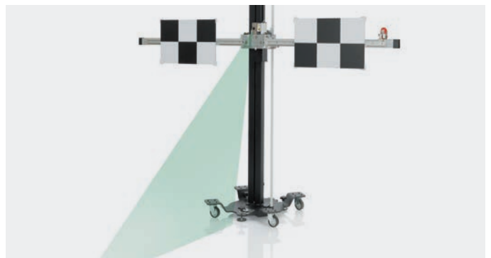
Ustawianie względem pojazdu za pomocą wiązki lasera
