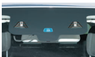
Usuwanie z szyby zespołu kamery
