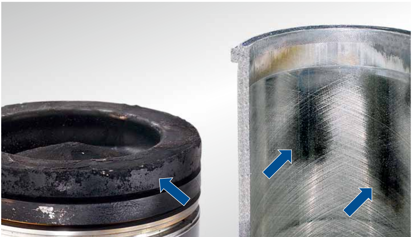
Rys. 4: Osad nagaru olejowego na progu ogniowym i zużycie ściernie powierzchni bieżnej cylindra
